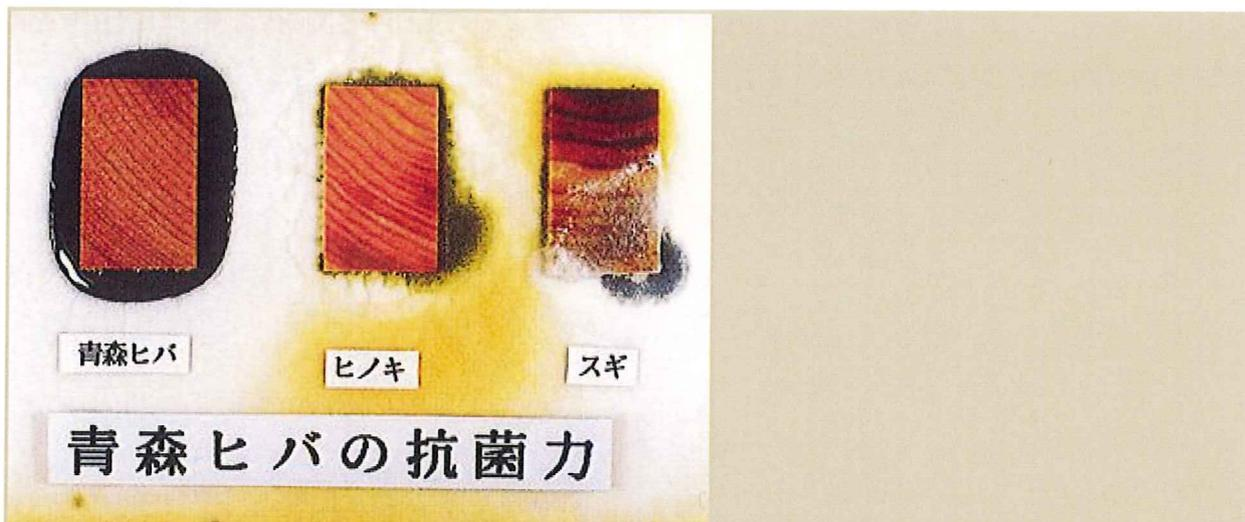
写真は黄コウジカビによる抗菌試験を示したものです。
